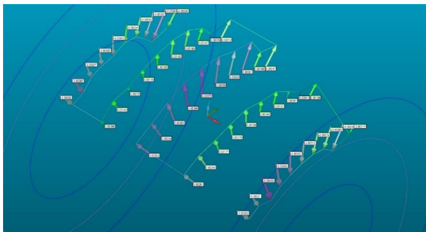
Рис.6. Результат измерения профиля МЭК g=20\text{мм} , e=4\text{мм}
