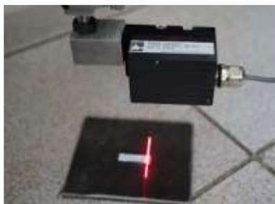
Рис.2. Внешний вид КМД, установленной на подложку для калибровки лазерного сканера.
