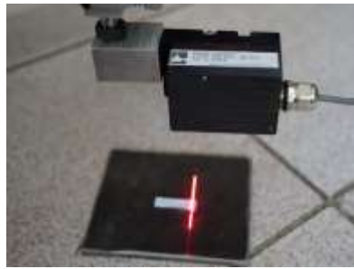
Рис.2. Расположение вспомогательной пластины и концевой меры
